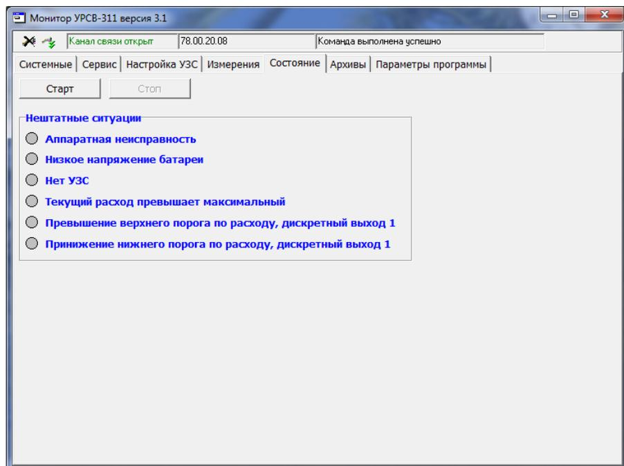
Рис.15. Окно «Состояние» программы «Монитор УРСВ-311».
