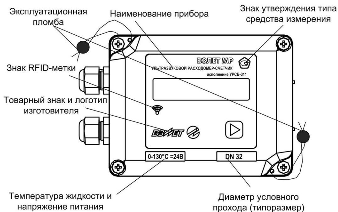
Рис.1. Маркировка вторичного преобразователя (ВП) расходомера.
