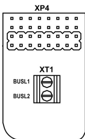
Интерфейс M-Bus соответствует стандарту EN 60870-5. Интерфейс позволяет считывать измеренные и архивные данные. Модуль интерфейса M-Bus (рис.9) устанавливается в модуль обработки по заказу.
