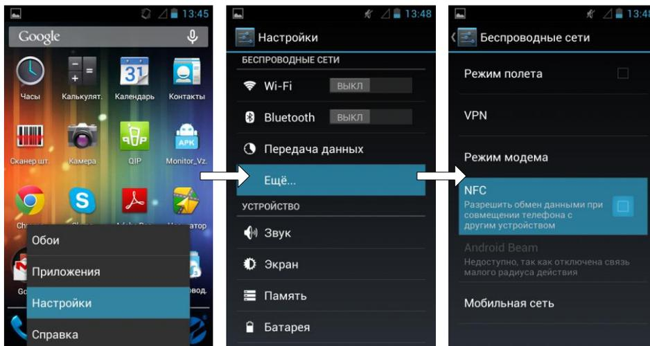
Для работы ПО «Монитор УРСВ-311» требуется, чтобы в настройках смартфона был включен NFC в соответствующем пункте меню (рис.21). Запуск приложения осуществляется нажатием на иконку, либо автоматически при поднесении телефона к расходомеру.
