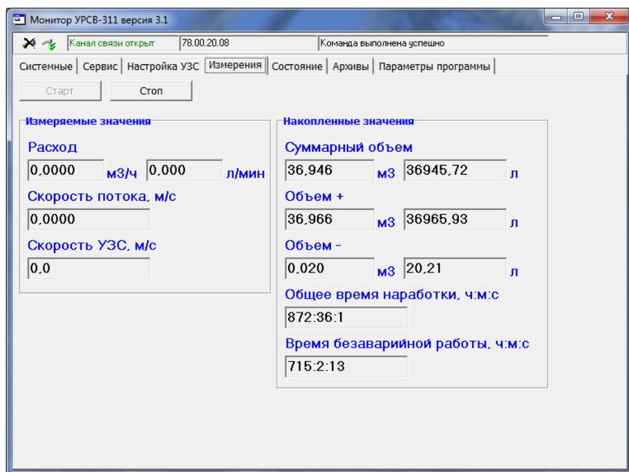
Рис.14. Окно «Измерения» программы «Монитор УРСВ-311».
