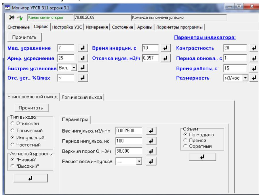
Для задания параметров работы универсального выхода необходимо в окне «Универсальный выход» задать тип выхода, после чего откроется окно с параметрами выхода в соответствующем режиме. Аналогично производится настройка логического выхода в окне «Логический выход».
