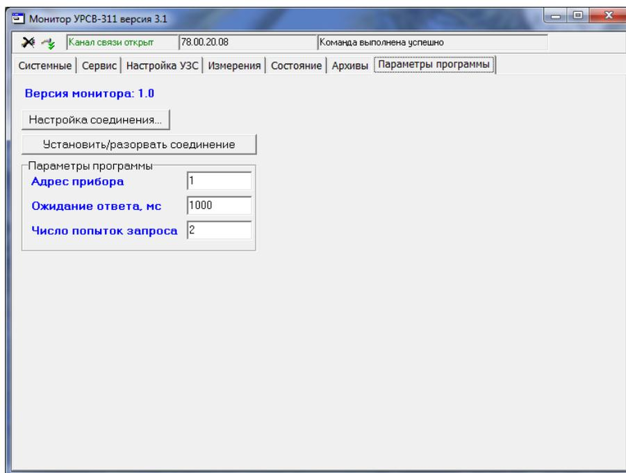
Рис.17. Окно «Параметры программы» программы «Монитор УРСВ-311».
