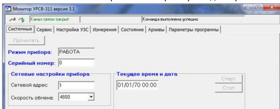
Настройка связи по интерфейсу с расходомером производится в окне «Параметры программы» нажатием кнопки «Настройка соединения».
