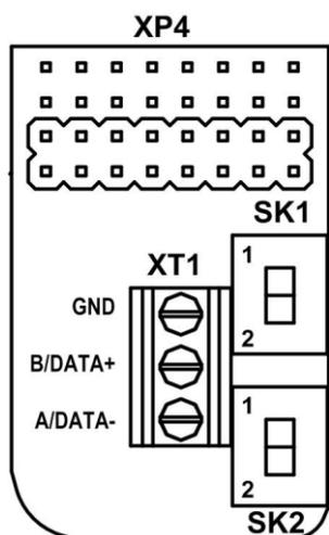
Последовательный интерфейс RS-485 позволяет вать измерительную, архивную, установочную и ческую информацию, модифицировать установочные параметры. Интерфейс RS-485 поддерживает протокол ModBus (RTU ModBus и ASCII ModBus), принятый в качестве стандартного в приборах фирмы «Взлет». Модуль интерфейса RS-485 (рис.8) устанавливается в модуль обработки по заказу.
