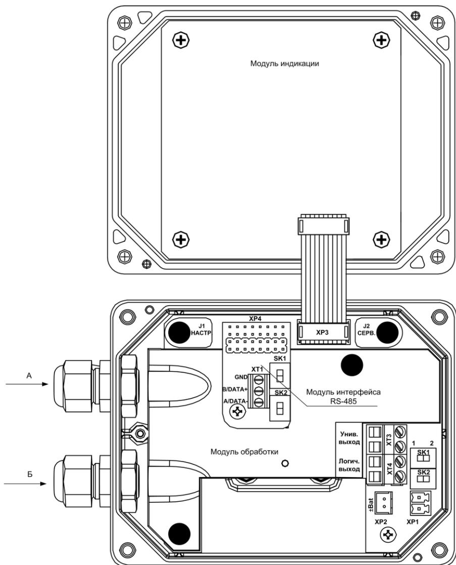
**Рис.4. Вторичный преобразователь с открытой крышкой.**
